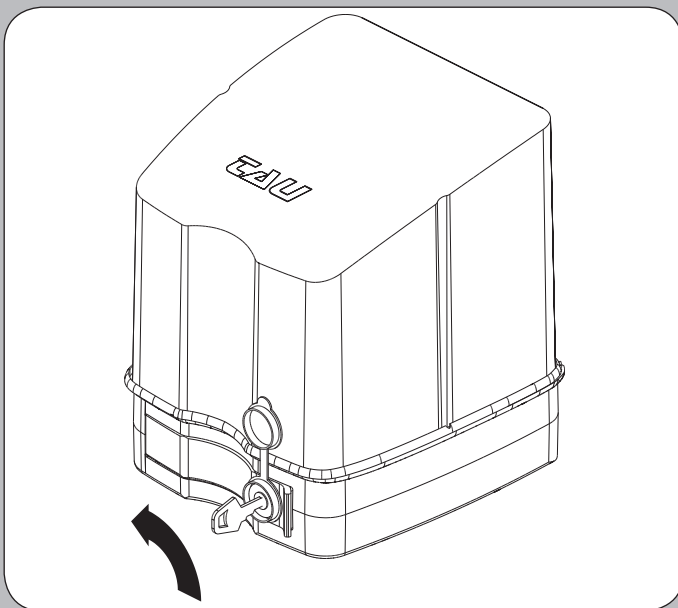
Bei Stromausfall, den Deckel des Schlosses heben, den Schlüssel einstecken und wie auf der Abbildung gezeigt drehen.
