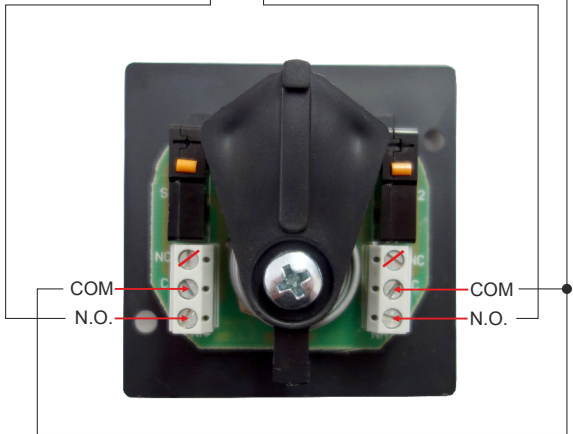
Start - Fußgänger COM - 6 N.O. - 8/9 Start COM - 6 N.O. - 10
