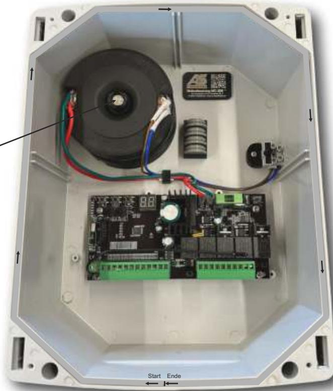
Beginnen Sie unten in der Mitte mit dem einsetzen der Dichtung. Führen Sie diese komplett bis zum Ende.
