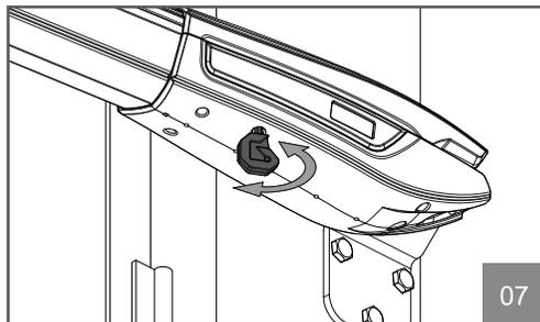
Führen Sie den Entriegelungsschlüssel in den gezeigten Schlitz im Bild 05 (linker installierter Motor) oder 06 (rechter installierter Motor).
