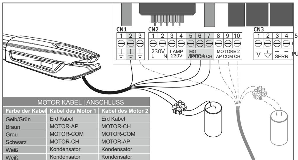
Die Verbindungen sollten wie oben gezeigt durchgeführt werden, durch anschliessen der 6 Motorkabel an den entsprechenden Eingängen der Steuerung und Kondensator.
