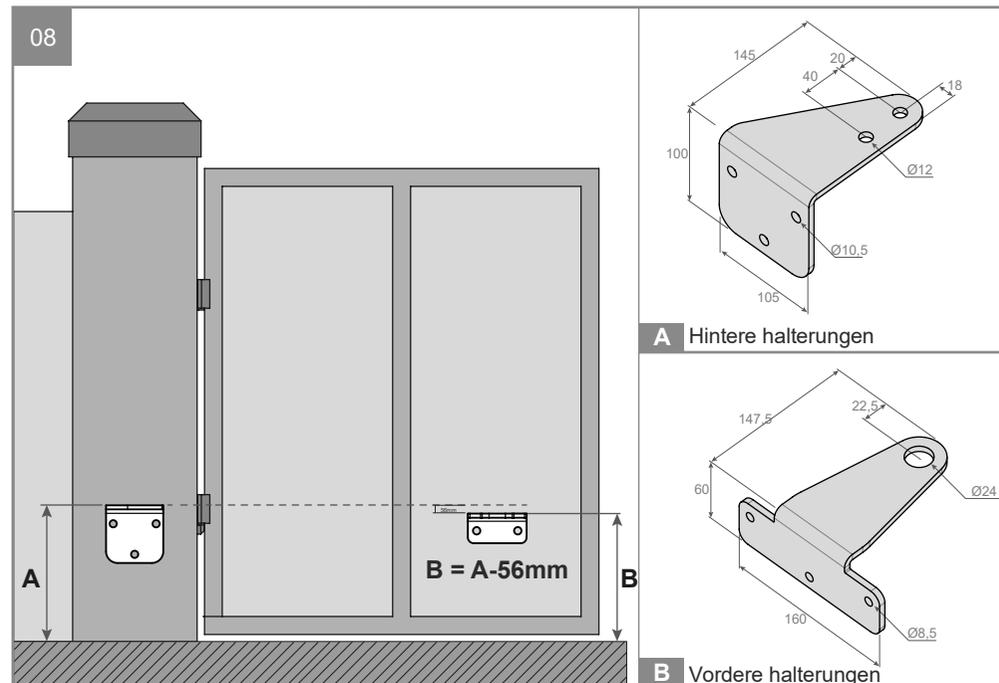
**Maß A** • Vertikaler Abstand vom Boden bis zur Oberkante der Halterung an der Säule.
