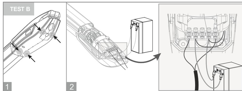
**Test B** • Lösen Sie die 4 Schrauben, um die Abdeckung zu entfernen und an die internen Kabel zu gelangen.
