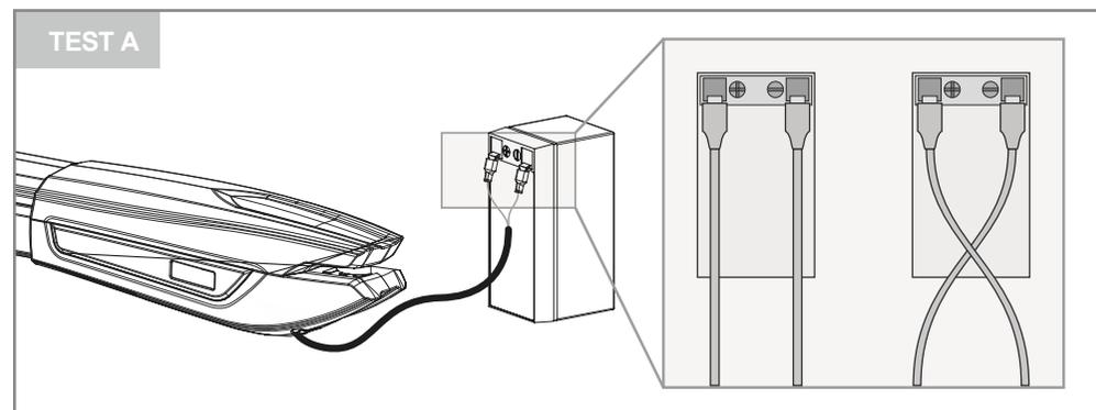
**Test A** • Führen Sie die Verbindungen wie in der Abbildung dargestellt. Wenn der Motor arbeitet, liegt das Problem an der Steuerung. Wenn nicht funktioniert, führen Sie den Test B durch.
