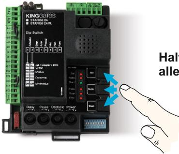
Halten Sie die Tasten „Set - Radio - Start“ für ca. 8 Sekunden gedrückt bis alle LED's blinken.
