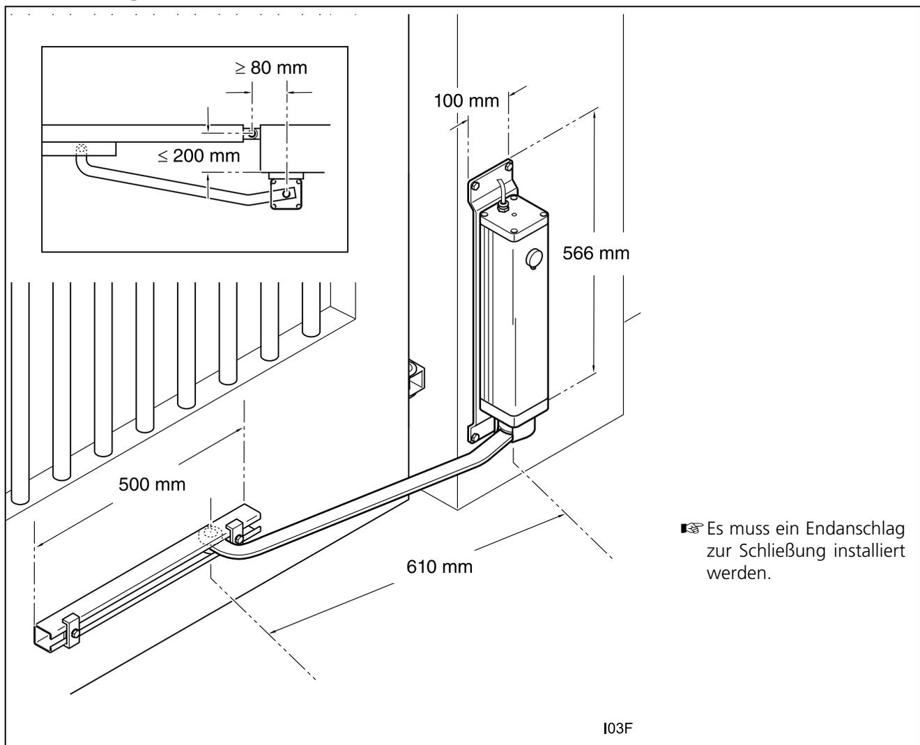
Abb. 4 Beispiel der Montageposition des Antriebs beim Schiebearm
