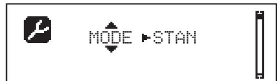
6. Mithilfe der Tasten **↑** **↓** und **OK** die notwendigen Parameter auswählen und ändern.: In den nächsten Seiten steht eine Tabelle zur Verfügung, mit allen Programmierungsparametern, den auswählbaren Werten, den eingestellten **DEFAULT** Werten und eine kurze Beschreibung der Funktion.
