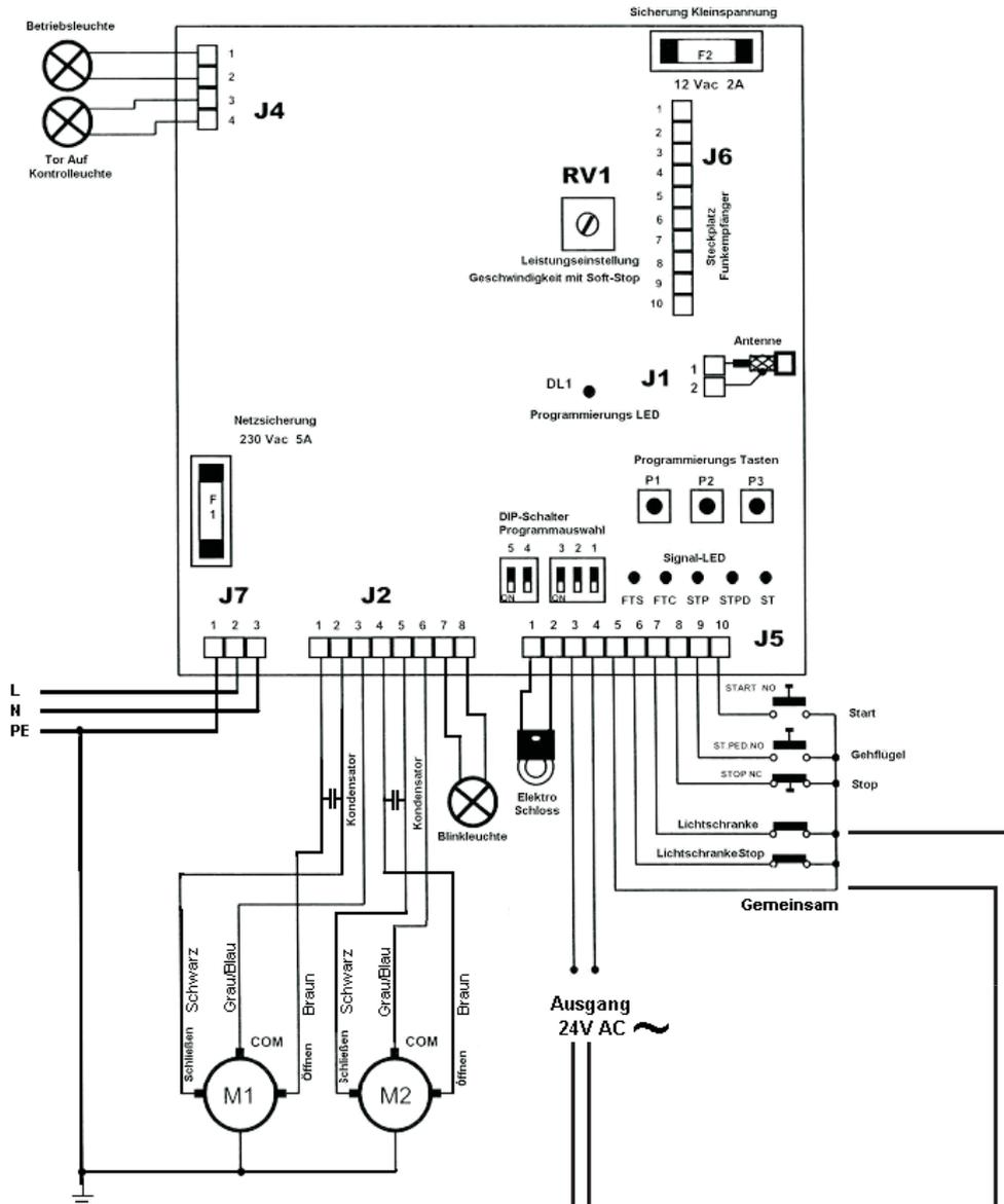
Info: die Drahtbrücke 6-7 wird entfernt und durch die Lichtschranke ersetzt
