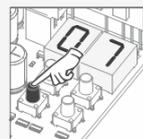
**05** • Drücken Sie cmd 3 Sekunden lang. Die Position ist leer. Das Display blinkt und die Position wird verfügbar.
