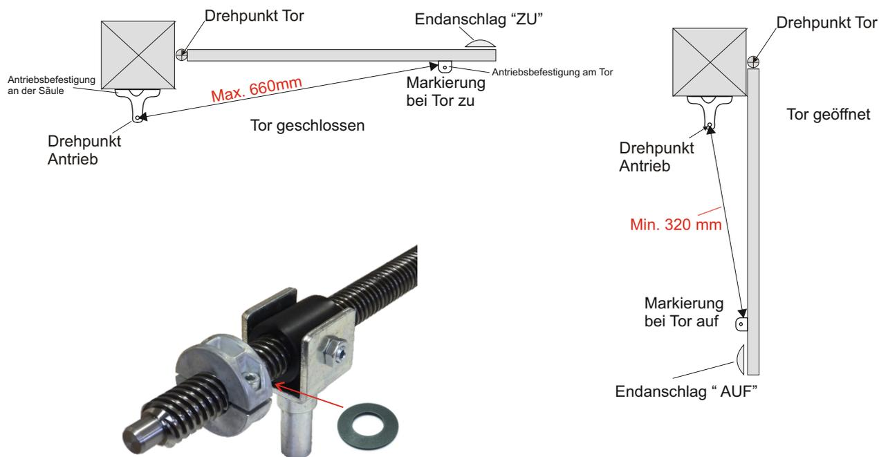
Die Tellerfeder wird in "ZU" zwischen dem Spindelmitnehmer und dem verstellbaren Endanschlag montiert.
