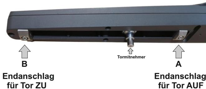
An dem Metallgehäuse des Antriebs befinden sich einstellbare mechanische Anschläge. Einer für den Anschlag des Tores beim öffnen (A), einer für den Anschlag des Tores beim schließen (B). Der mechanische Anschlag kann mit einem Sechskantschlüssel gelöst und eingestellt werden. Somit kann die AUF / ZU Position des Tores sehr genau justiert werden.
