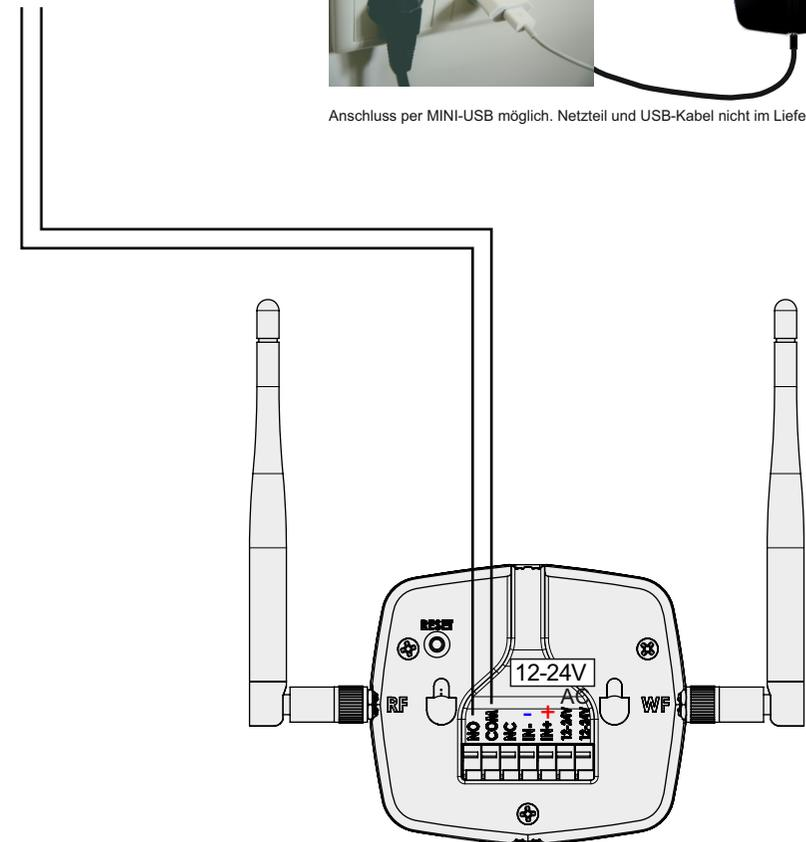
**Hinweis** • Wenn das Gerät über USB angeschlossen ist, verwenden Sie zur Verwendung des Eingangs eine externe 12/24-V-Quelle.
