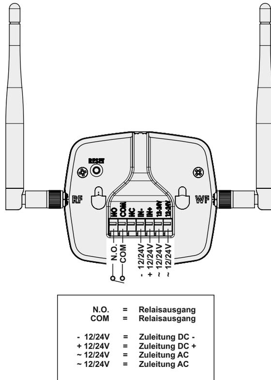
Der Relaisausgang N.O. und COM wird direkt auf der Motorsteuerung auf COM und START angeschlossen.
